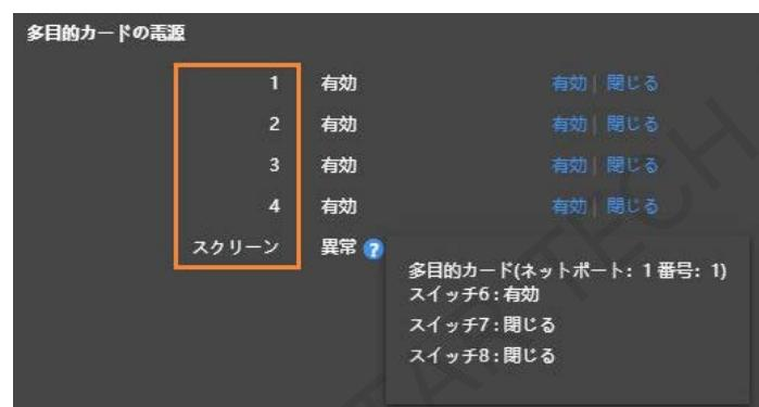
緑ボックスにあるタグは NovaLCT でカスタマイズされており、リレー電気回路に1回路か数回路関連付けられます。複数回路の場合は、回路をいずれもオン（もしくはオフ）にしている場合は、画面に「オン」（もしくは「オフ」）が表示されます。または画面に「異常」が表示され、各回路の詳細情報が表示されます。
