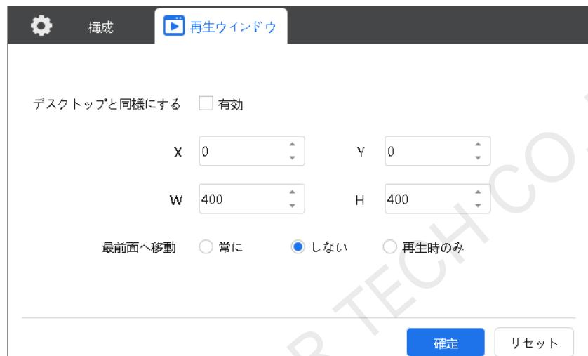
手順3 再生ウィンドウの位置・サイズ・最前面へ移動のルールを設定します。
