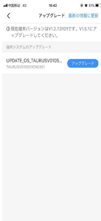
図10-3 ワイドエリアネットワーク経由でアップグレードパッケージを取得
